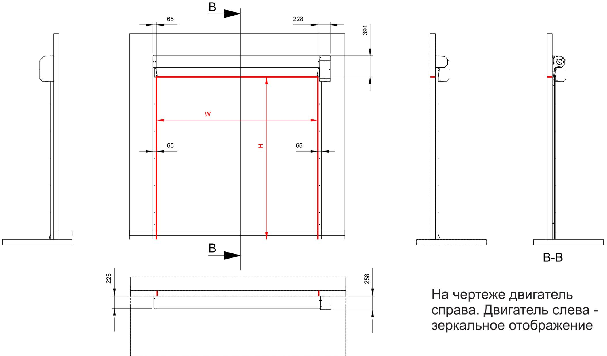
На чертеже двигатель справа. Двигатель слева - зеркальное отображение
