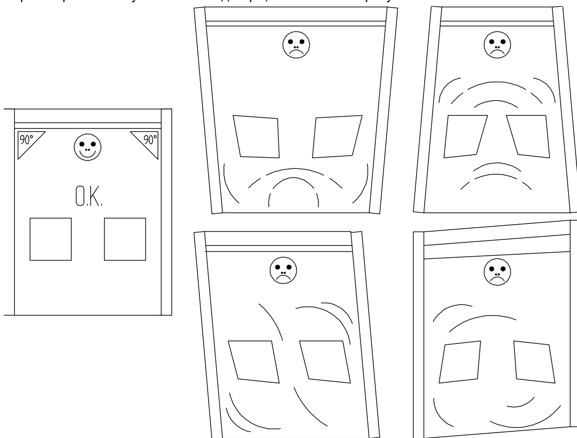
Рисунок 6-8. Установка ворот под правильными углами
