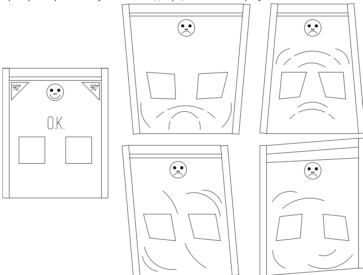
Рисунок 6-7. Установка ворот под правильными углами
