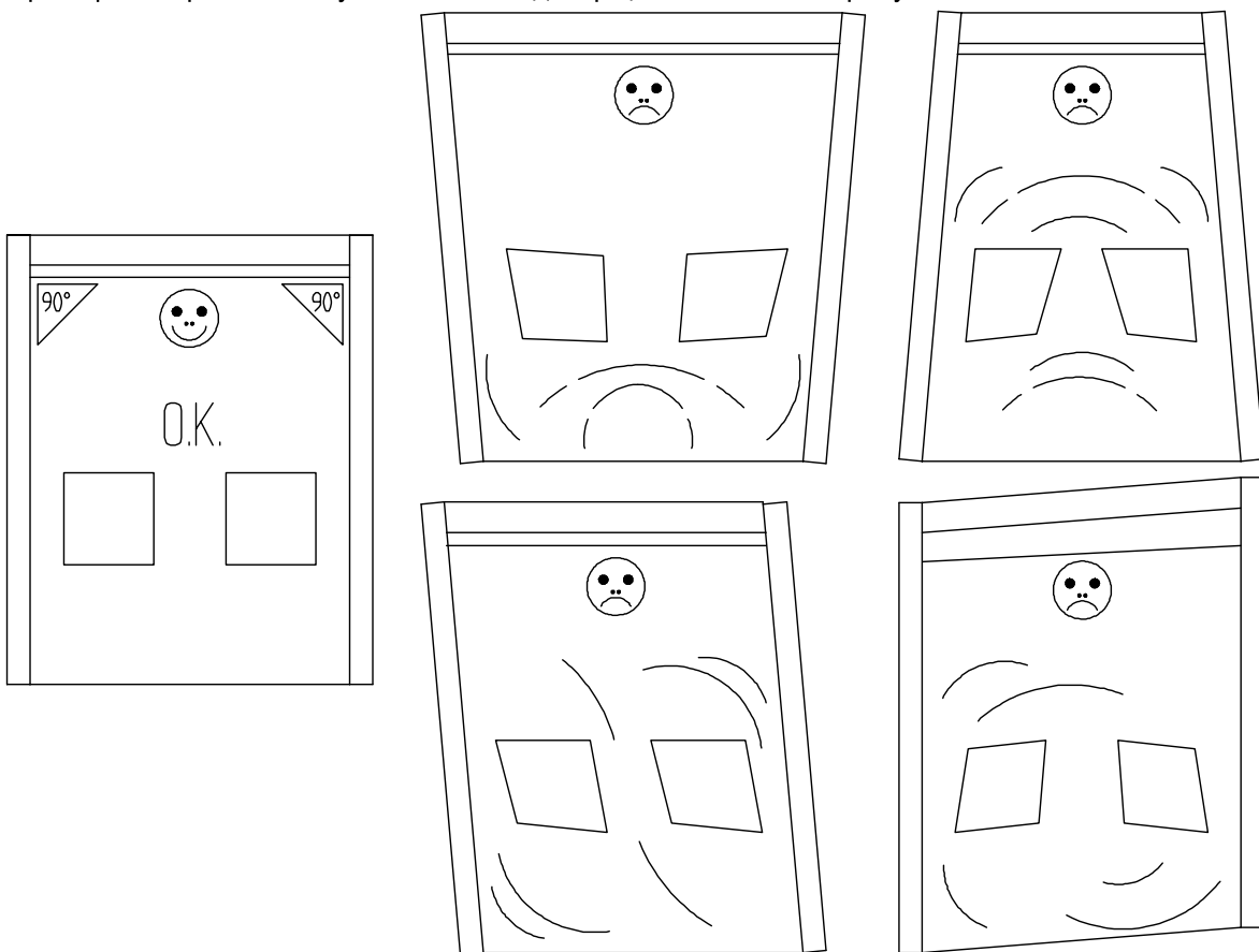
Рисунок 5-7. Установка ворот под правильными углами
